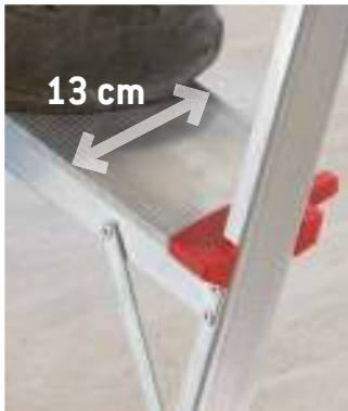
Peldaños de 13 cm fijados con dos remaches de acero de 5 mm de gran resistencia.
