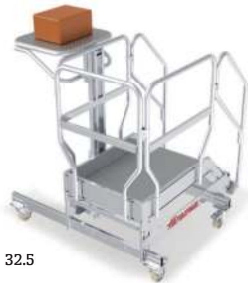
Accesorio motorizado para elevar materiales, aplicable lateralmente o posteriormente en Scala System. Alimentación con batería recargable. Capacidad 100 kg.
