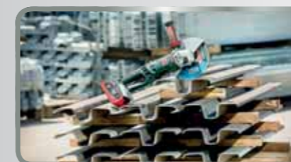
11 cortes de guardarraíles, Material: chapa de acero
