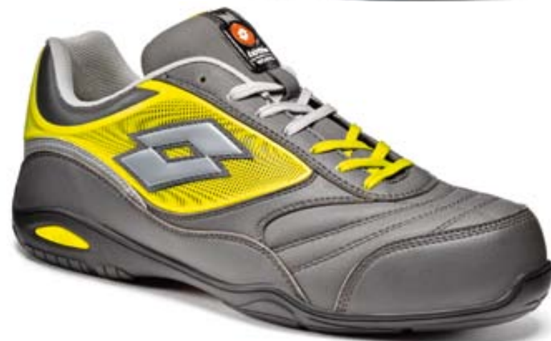
Q8411 ENERGY 700 S3 EN 20345 (S3 SRA HRO) Gris / Amarillo Empeine: Microfibra con micro-inyección, hidrorrepelente. Forro: Air Mesh con forro antideslizante en microfibra Suela: Goma (HRO) / EVA Plantilla interior: Polietileno anatómico + EVA Lámina: Antiperforante y de elevada flexibilidad (material textil) Puntera: FLYcap (composite) Tallas: 38-46
