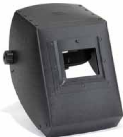
501 PANTALLA PLANA PARA SOLDADOR EN175 Pantalla plana en material termoplástico , dimensión del visor 75x98 mm. Embalaje: 50 piezas por caja.
