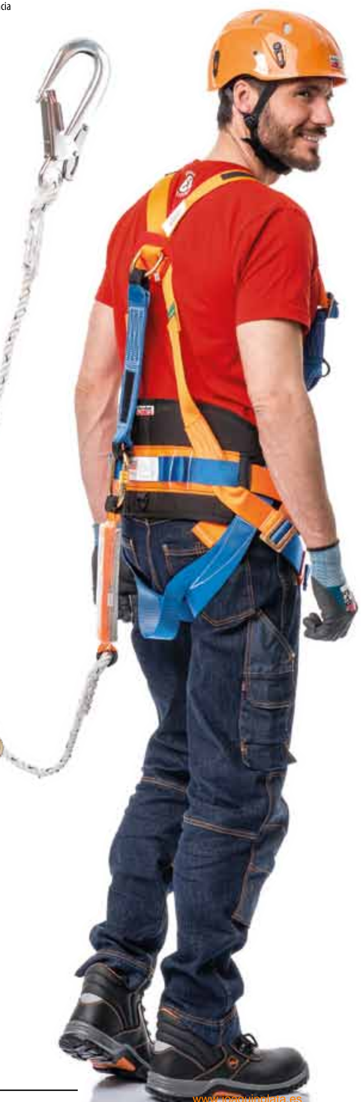
AK005 ARNÉS AKROBAT EN361 – EN358 Puntos de anclaje: 2: dorsal y frontal con cinturón de posicionamiento. Embalaje: 10 pz.
