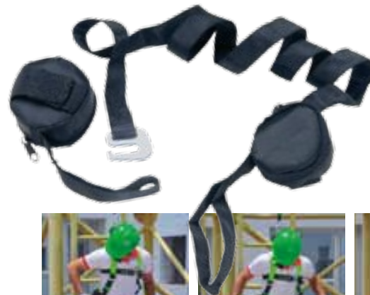
AKIS01 BANDAS DE SUSPENSIÓN Específicamente estudiado para aliviar el efecto negativo de estar suspendido después de una caída. En caso de caída, extraer las dos bandas, atarlas juntas y apoyar el pie en la cinta, luego pedir ayuda. (ver foto). Embalaje: 1 pieza.
